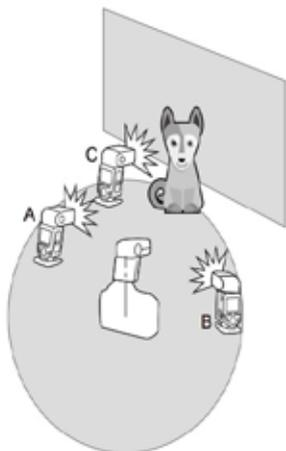
Drahtlos gesteuerte Blitzaufnahmen mit Funkübertragung haben Vorteile gegenüber der optischen Übertragung. Diese Vorteile sind beispielsweise eine geringere Anfälligkeit gegenüber Hindernissen und die Tatsache, dass der Drahtlos-Sensor des Slave Blitzgerätes nicht auf das Master Blitzgerät ausgerichtet werden muss. Nachfolgend sind die wichtigsten Funktionsunterschiede aufgelistet:
