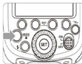
**1** Drücken Sie die <MODE> Taste bis <M> angezeigt wird.
