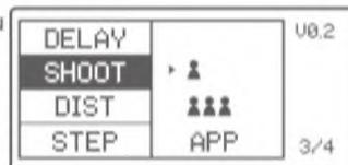
**Einzelaufnahme:** Wählen Sie beim Fotografieren Einzelaufnahme. Im M- und Multi-Modus sendet die Master-Einheit nur Auslösesignale an die Slave-Einheit, was für Ein-Personen-Fotografie vorteilhaft ist, da dadurch Strom gespart wird.
