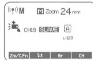
Display angezeigt. Drücken Sie die <CH>-Taste, um den gleichen Kanal für den Blitzauslöser einzustellen, und die <Gr>-Taste, um die gleiche Gruppe für den Blitzauslöser einzustellen (Hinweis: Bitte beachten Sie die entsprechende Bedienungsanleitung, wenn Sie die Kamerablitz anderer Modelle einstellen).
