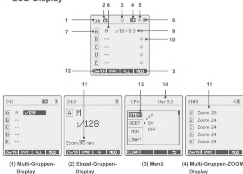
1. Kanal (32) 2. Kameraverbindung 3. Modellierungsleuchte Master-Steuerung
