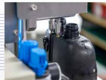
Die Steiner-Stickstoff-Druck-Befüllung verhindert das Eindringen von Schmutz und Feuchtigkeit ins Innere des Fernglases. Ein Beschlagen der Linsen oder die Bildung von Kondenswasser sind, dank dieser firmeneigenen Hightech-Lösung, ausgeschlossen. Durch das einzigartige Verfahren der Befüllung über die 2-Wege-Ventil-Technik ist eine Wartung des Fernglases selbst nach vielen Jahren noch möglich.
